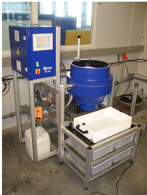
CF 32 mit Sieb und Schubladen With sieve and media drawers
