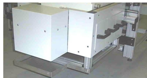
Siebwagen für CF 50 auf Verschiebeschlitten Trolley with sieves on vertical slide
